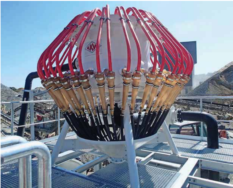
Erste Hydrozyklonstufe AKA-SPIDER zur Klassierung.
