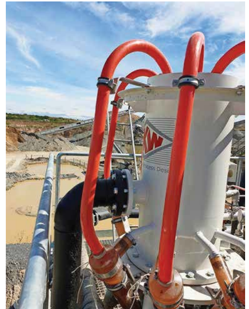
Zweite Hydrozyklonstufe AKA-SPIDER zur Eindickung.
