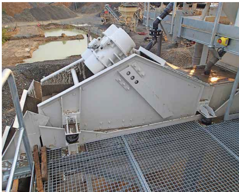
Entwässerungssieb, speziell für ultrafeines Material entwickelt.
