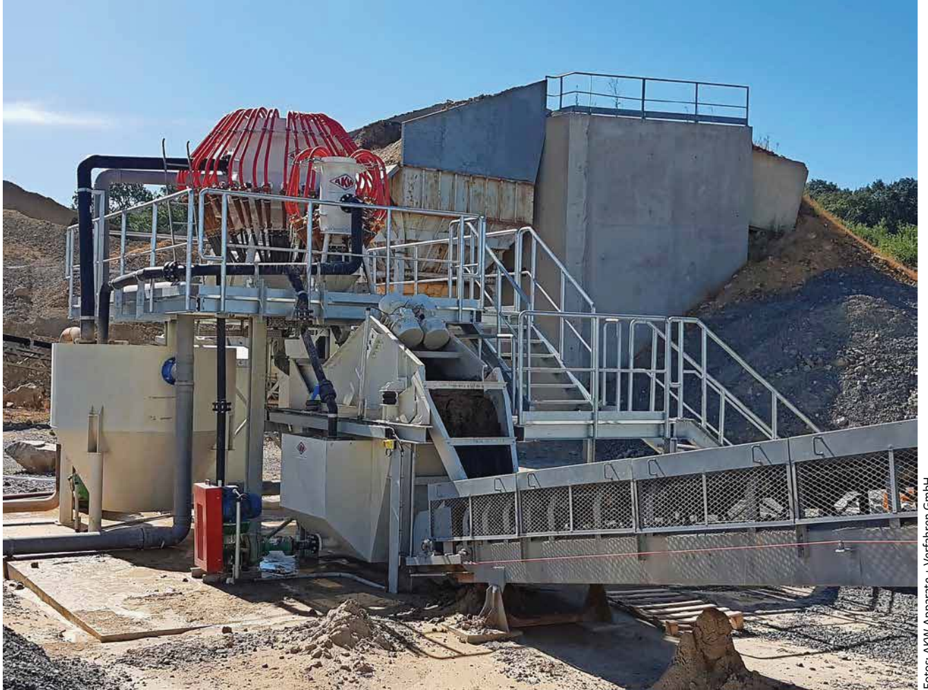
Ultrafeine Hydrozyklonklassierung kombiniert mit der Entwässerung von kritischem Sandmaterial: das sog. AKA-SILT-System.
