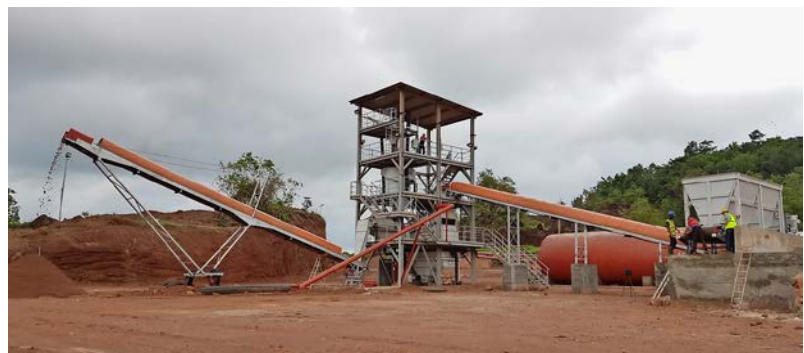
Mit dieser Bauxit-Waschanlage kann nach der Aufbereitung und Klassierung durch den vorgeschalteten Aufstromklassierer Aka-Sizer bis zu 50 % bzw. 100 t/h an Wertstoffen zurückgewonnen werden
